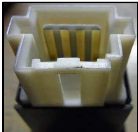
非常点滅灯スイッチのソケット
