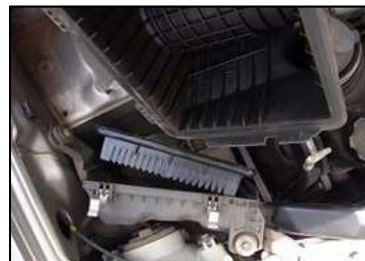
ステップ-6 古いフィルターを取った後、状態を確認する。
