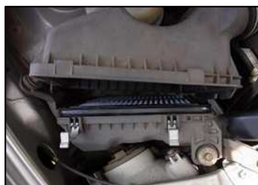
ステップ-4 後ろ側のカバーを、フィルターが入っている ハウジングからはなす。
