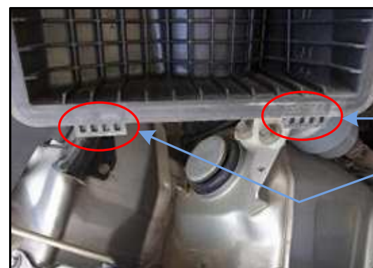
ステップ-8 後ろ側のカバーを元に戻す。注意点は、下の方にあ る2つの固定用の”タブ”。
