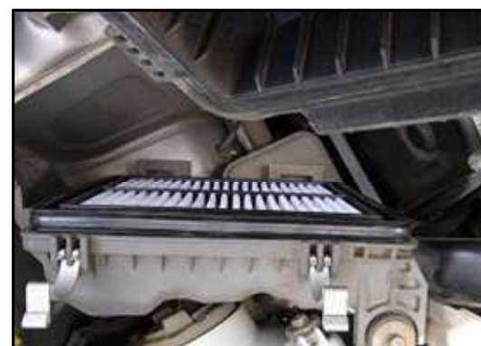
ステップ-7 古いフィルターの状態がよければ、再使用する。 悪ければ、新品と交換する。
