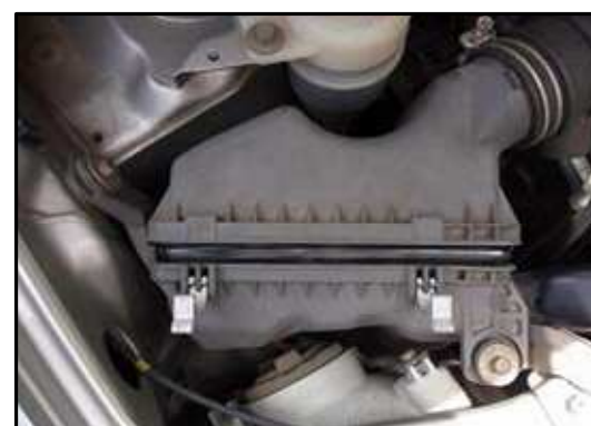
ステップ-9 後ろ側のカバーとフィルターが入っている ハウジングの回りすべてが平らになってい るかどうかを確認する。
