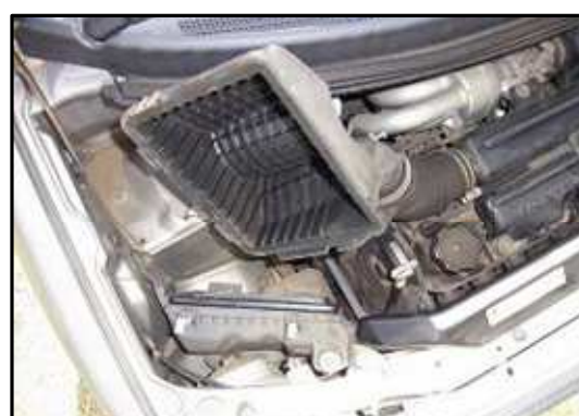
ステップ-5 フィルターに注意しながら、後ろ側のカバー及びエア ーホースをフィルターが取れるように、動かす。
